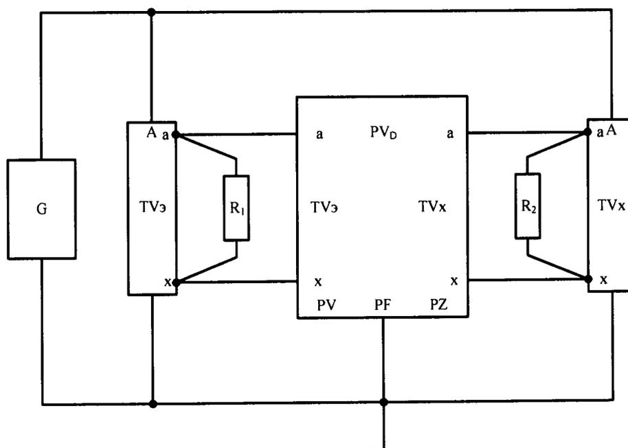
G- источник высокого напряжения; TVЭ - эталонный трансформатор; R<sub>1</sub> - нагрузочное устройство эталонного трансформатора; TVx - проверяемое устройство I-TOR-6/10-U; R<sub>2</sub> - нагрузочное устройство канала напряжения устройства I-TOR; PV<sub>Δ</sub> - прибор сравнения; PF – частотомер.
